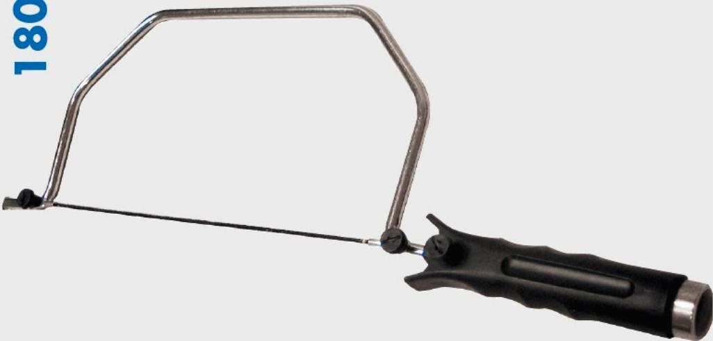
Scie à main équipée : d'une poignée démontable, tournante avec système de blocage, d'une mèche au carbure de tungstène **Ø 10 mm** à l'extrémité de la scie, d'un fil interchangeable au carbure de tungstène de **300 mm**.
